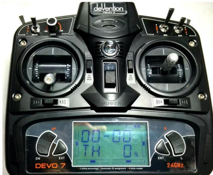
이제 서로 연동된 조종기와 수신기를 FIXID(고정)해줘야 합니다. 옆에 ENT를 눌러서 SYSTEM을 띄운 후 화살표 방향으로 MODEL 카테고리 쪽으로 가줍니다. 그 후 밑으로 내려가서 제일 밑의 FIXID로 가서 ENT를 눌러줍니다.
