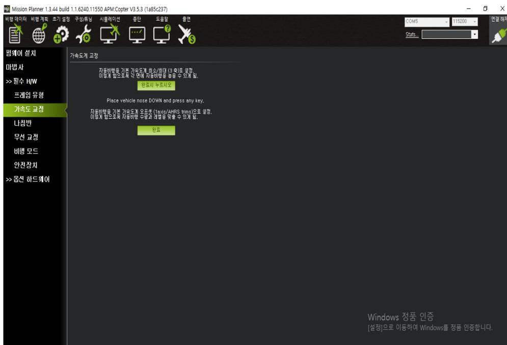
Place vehicle nose DOWN and press any key 라는 메시지가 나타납니다.
