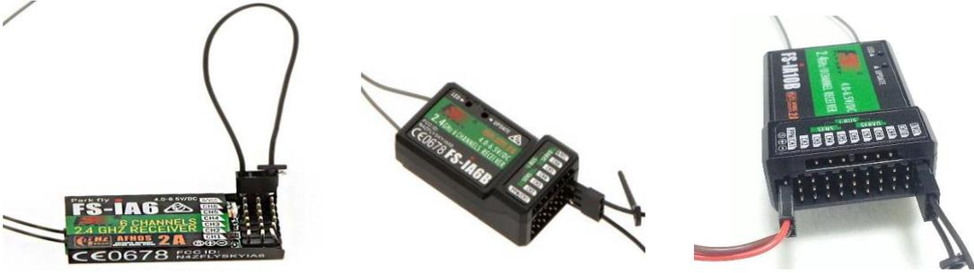
Drone 에 배터리 단자를 연결하면 FC 에 전원이 들어가며 변속기를 통하여 수신기 까지 5V 가 전달 되어 수신기에 적색 LED 가 깜빡이는 것을 볼 수 있습니다. 깜빡이는 LED 는 아직 조종기와 연결이 안되어 있다는 뜻이고 수신기는 잘 작동한다는 말입니다.
