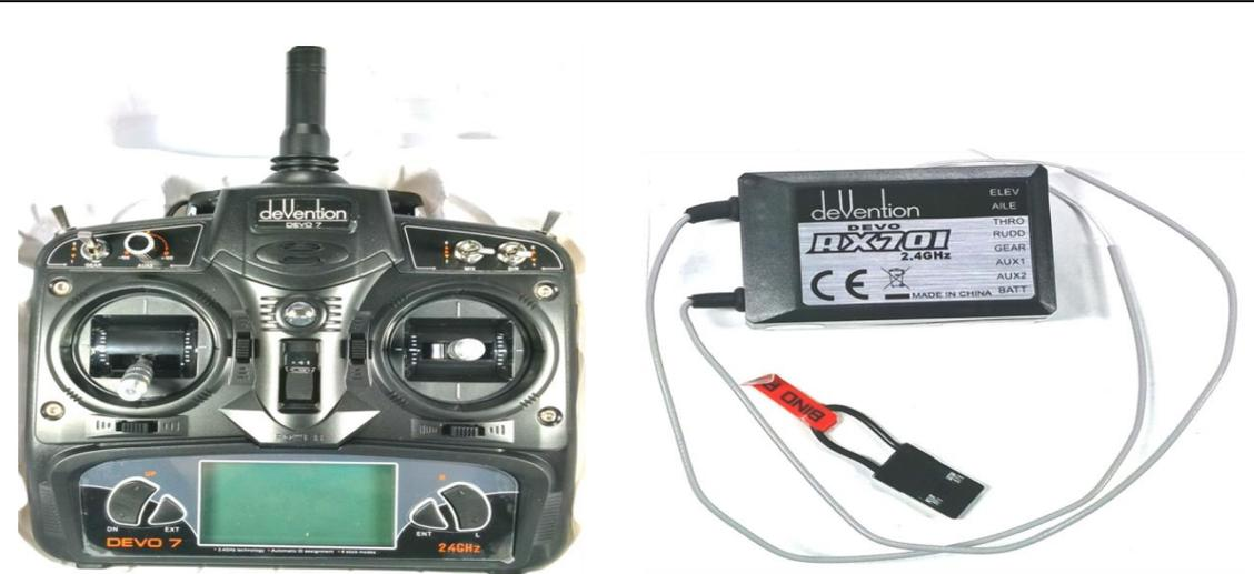
먼저 수신기 set에 들어있던 BIND Plug를 위 그림과 같이 BATT단자에 연결해줍니다. 그 후 Drone에 배터리를 연결합니다.
